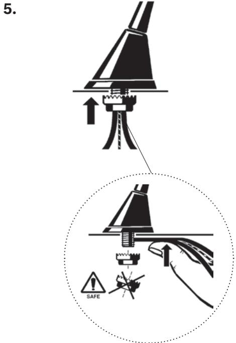
Anschlussbeispiele / Connection examples / Exemples de branchement / Esempi di allacciamento / Voorbeelden van de aansluiting / Anslutningsexempel / Ejemplos de conexión / Exemplos de ligação / Tilslutningseksempler / Przykłady podłączenia / Příklady připojení / Příklady pripojenia / Παραδείγματα σύνδεσης / Bağlantı örnekleri / Kytkenäesimerkkejä / Примеры подключения /
